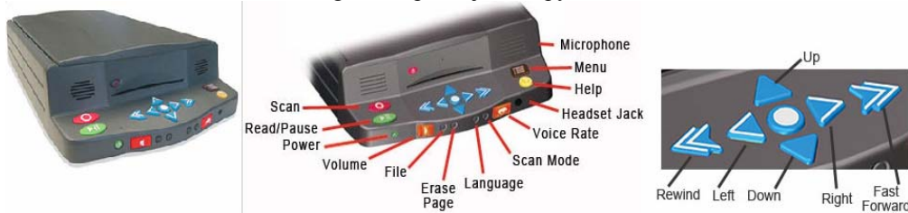
Slika3: Slika skenera SARA sa detaljima komandne table
